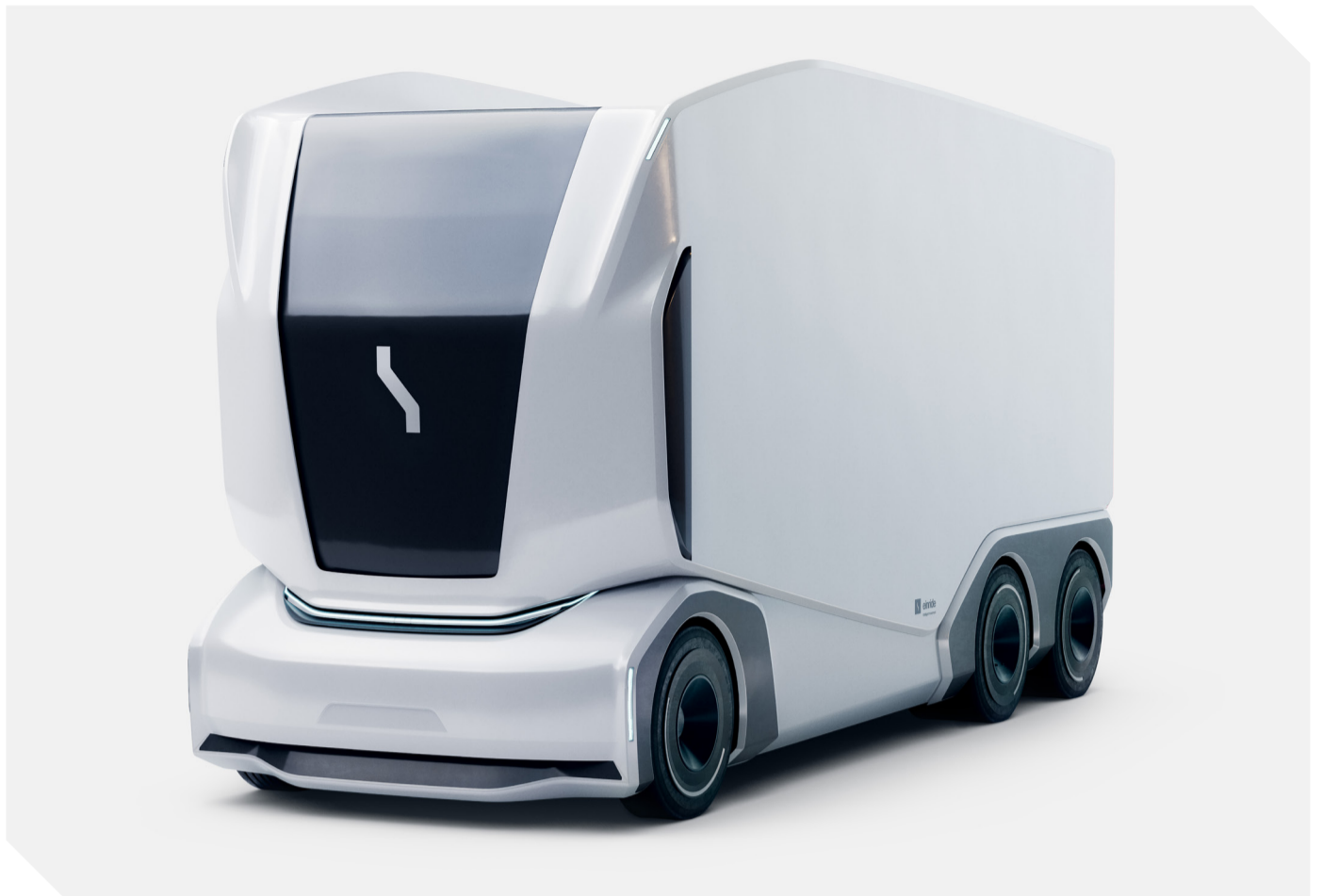
Les concepts de camions autonomes sont peu nombreux. Ici, la 2ème génération du camion électrique autonome T-Pod sans cabine de Einride. Le Gen 2 Rigid Large.
