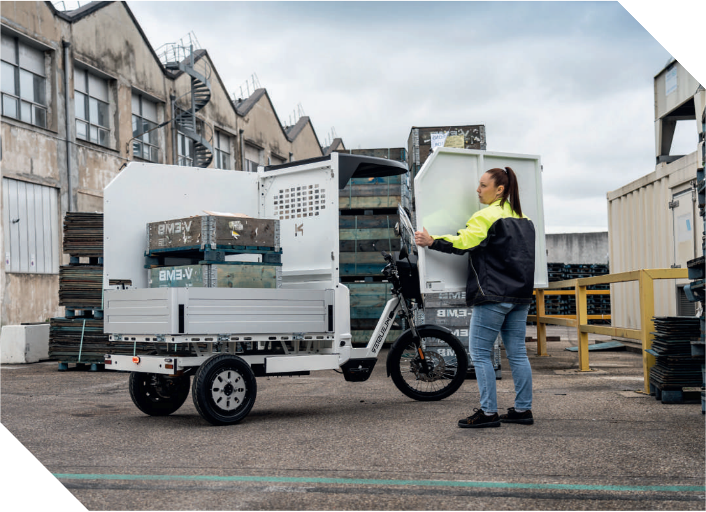
Renault Trucks Kleuster 350, vélo-cargo électrique conçu pour un usage intensif en milieu urbain, capacité de charge de 150 à 300 Kg.
